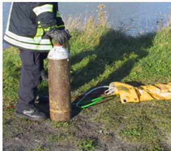
Befüllen der Ölsperre mit der Pressluftflasche (300 bar)
